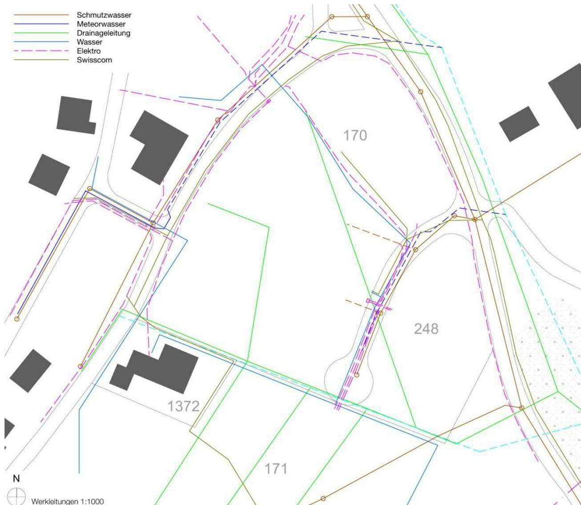
Abbildung 4 Bestehende Werk- und Drainageleitungen
